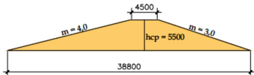
Рисунок 2.5 – Вид ограждающей дамбы
