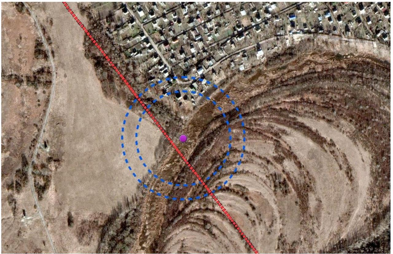
Рисунок 5.3.2 Положение границы зоны влияния при водопонижении грунтовых вод при строительстве насосной станции
