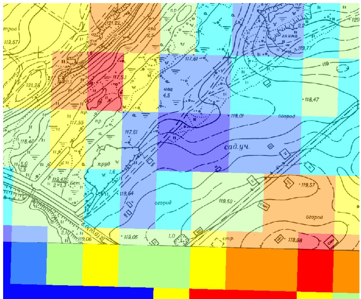
Рисунок 3.6 – Верификация ЦМР с данными топографической съемки
