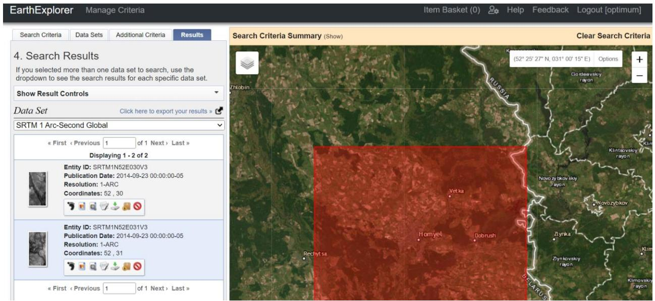
Рисунок 3.5 – Панель выбора цифровых данных рельефа местности
