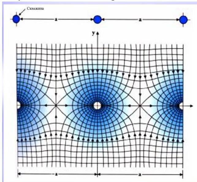
Рисунок 5.3.1 Структура гидродинамической сети грунтовых вод при линейном расположении водопонижающих скважин
