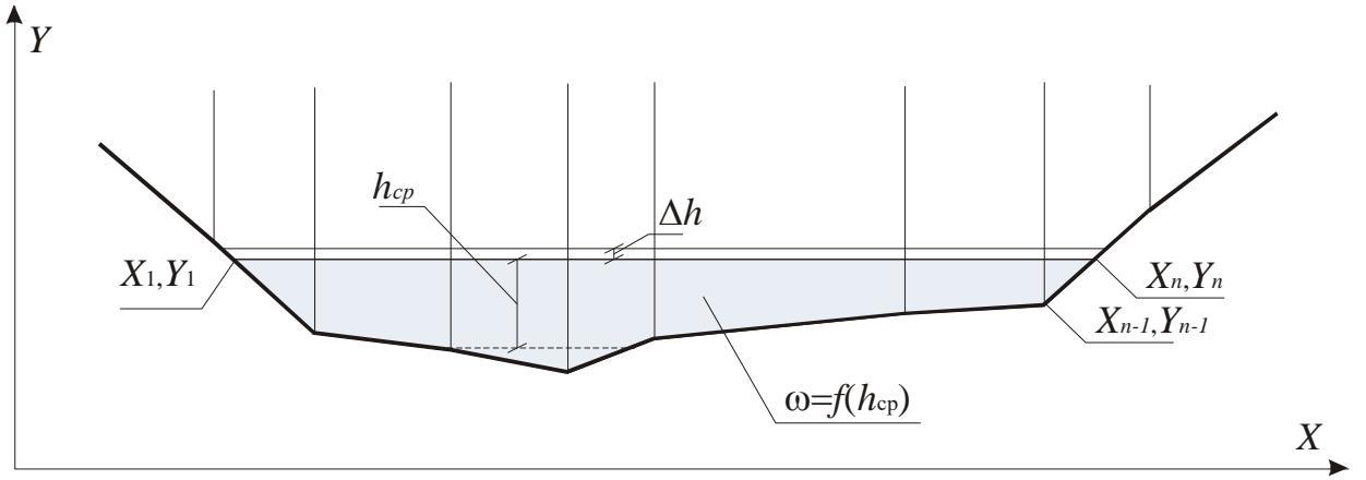
Рисунок 3.10 – Схема численной обработки данных промерных работ
